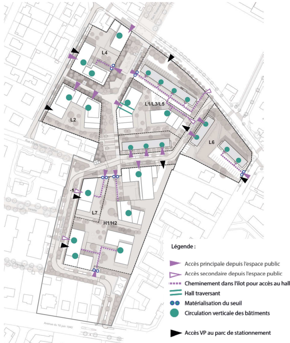
Illustration 30 : Schéma de principe des accès piétons et véhicules aux lots. Source : CPAUPE
