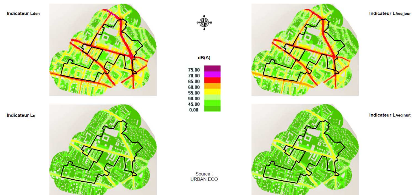
Illustration 162 : Résultats de la modélisation acoustique de 2014. Source : SOLDATA ACOUSTIC
