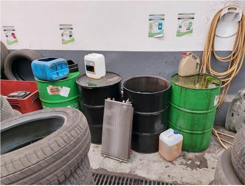
Fûts d'huiles, bacs de collectes et fuite dans l'air de lavage
